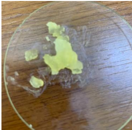
სურ. 4. ნახშირის მიღების დროს მიღებული თანაპროდუქტი
