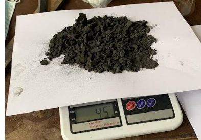
სურა. 5. პლასტმასის ნარჩენებისგან მიღებული ნახშირი
